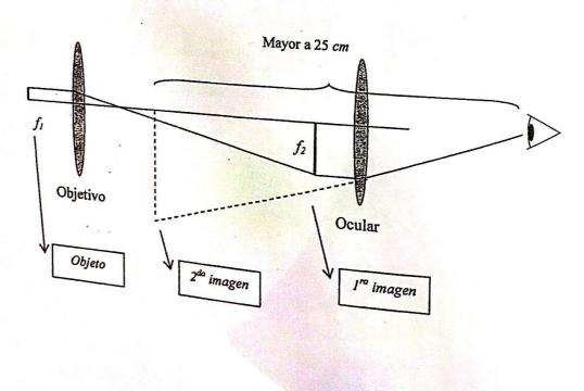
Como la primera lente invirtió la imagen, y la 2<sup>da</sup> no, el resultado final es una imagen invertida respecto del objeto original. El enfoque consiste en estos instrumentos, en mover el sistema de lentes al mismo tiempo (la distancia entre ellas permanece fija) hasta que el objeto quede ubicado en la posición correcta: un poco antes del foco fi
