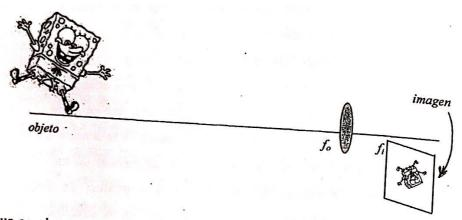
El enfoque consiste en mover la posición de la lente respecto del film, hasta lograr que la posición imagen x' quede sobre la película.
