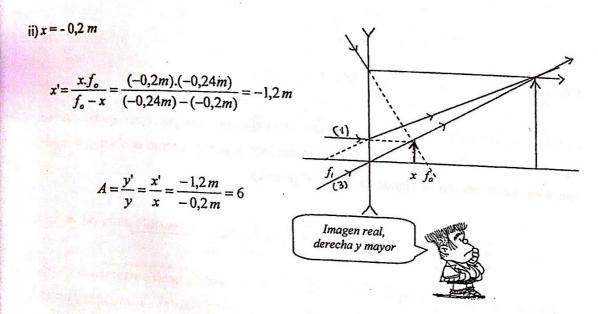
Entonces, como x' dio negativa, significa que la imagen es real, como el aumento A es positivo la imagen es derecha, y como |A| > 1 la imagen es de mayor tamaño. Para el trazado de rayos, te marco en el dibujo los tres rayos principales. El objeto virtual fue trazado en línea punteada del lado derecho de la lente, pero como siempre, los rayos inciden desde la izquierda.
